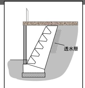
これらの擁壁形態は、宅地利用の場合、いずれも現行不適格となることが多く、被災時に現状復帰ができない又は認められなければ、現行法規に適合する擁壁構造での再構築が必要となる。なお、現行法に適合している擁壁でも、裏込め土の施工不良や締固め不足、水抜き穴など排水施設の不良、不備が認められるときには、被災危険度が高まるので要注意。
