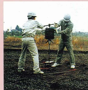
スウェーデン式サウンディング試験 ・一宅地当り数箇所調査します ・作業時間は2人で2~3時間
